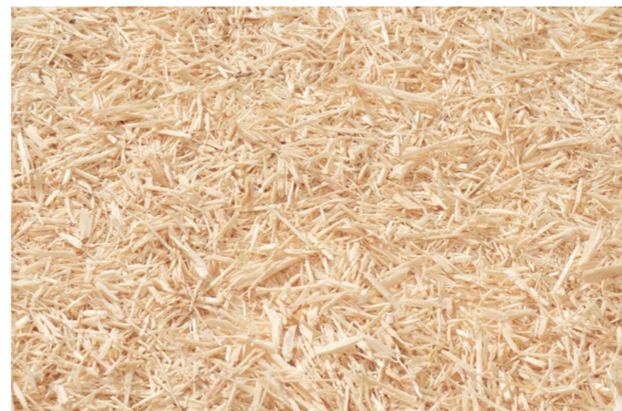
↑ Cavaco de madeira a jusante do moinho de martelos
