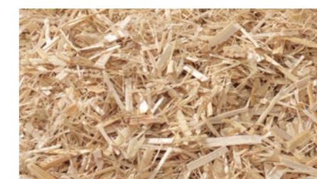
↑ Palha de girassol a jusante do moinho de martelos
